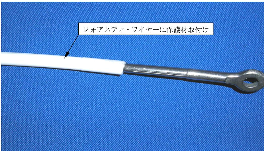
\*フォアスティ・ワイヤーにプラスチック系のパイプを半割りにしてジブハンクスの間に取付け、ワイヤーとジェネカーセール及びシートの摩擦をなくす。
